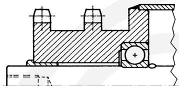
Stahlkettenrad 5/8"x3/8" z13 oder z15 mit Rohr verschweisst. Rillenkugellager 6204/6005 auch als ZZ oder 2RS erhältlich.
